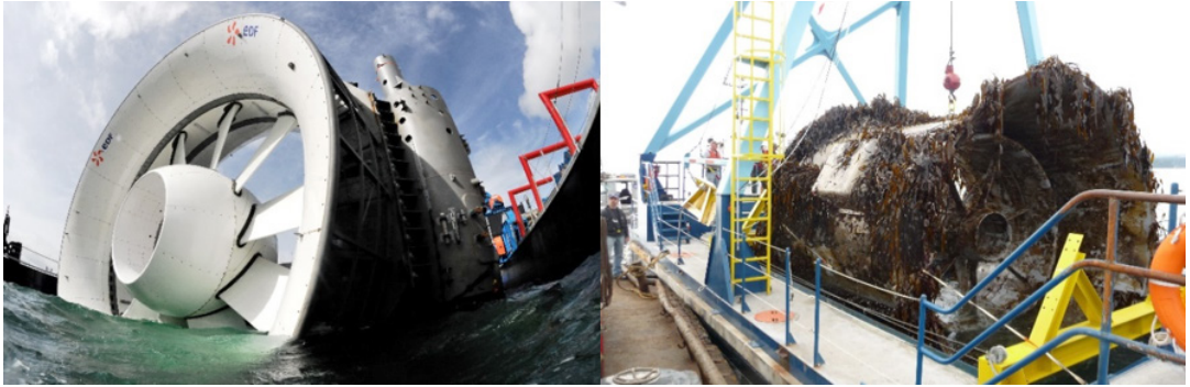
Figura 5. Turbinas para a geração de energia das marés (à esquerda, foto: DTOcean, http://www.DTOcean.eu ) e após o tempo de imersão, com incrustação de macroalgas (à direita).
